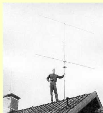
2x10 element hembyggd 2 m-beam, höj- och sänkbar från vinden med inomhus armstrongrotor. OBS tratt som regnskydd!
